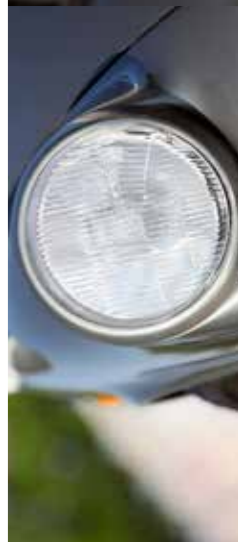
Phares L'éclairage nocturne n'est pas le point fort de la 911 Carrera 3.2. Cela va un peu mieux en supprimant les gâchettes obligatoires en France à l'époque et en installant des ampoules de 55 watts, mais si vous voulez mettre des 100 watts, il faut impérativement modifier le faisceau qui n'est pas assez résistant donc surchauffe et peut provoquer des courts-circuits, voire des incendies.
