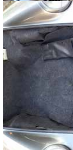
Coffre avant C'est là que les Carrera 3.2 ont le plus de soucis d'avoir souffert, soit lors d'accidents, soit de la corrosion, le traitement apposé en usine l'y plus de 26 ans n'étant pas extrêmement efficace. Il est donc indispensable de soulever la mallette avant l'achat afin de s'assurer que le dessous est aussi propre que le dessus.
