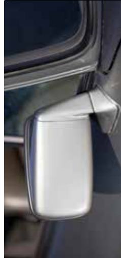
Rétroviseurs Hormis sur la version ClubSport, les rétroviseurs possèdent un réglage électrique placé sur la porte conducteur, un inverseur sous la planche de bord permettant de passer du rétroviseur gauche au rétroviseur droit.
