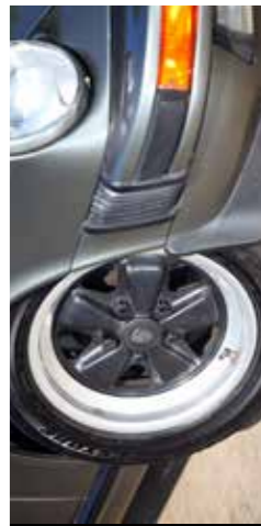
Jantes Selon les millésimes et les options, les Carrera 3.2 ont été livrées avec des jantes de 15 ou de 16 pouces de diamètre. Les jantes Fuchs à 5 branches sont emblématiques de ce modèle contrairement aux jantes "téléphone" qui équipaient en série les premiers millésimes. A l'avant, la largeur varie entre 6 et 7 pouces tandis qu'à l'arrière, elle va de 7 à 9 pouces.
