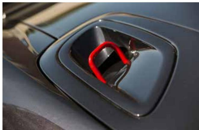
La capote est simplement fixée par ces petits crochets rouges intégrés au capot arrière
