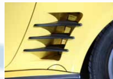
Les prises d'air servent à ventiler à la fois les freins arrière et la transmission
