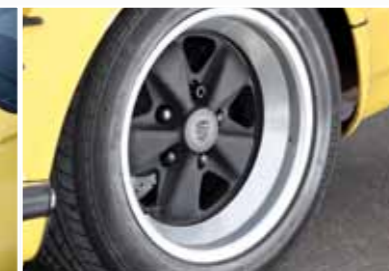
Les jantes Fuchs ont les mêmes dimensions que sur la 930 Turbo
