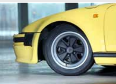
À l'avant, seul le pare-chocs et les jantes sont identiques à la 930 Turbo
