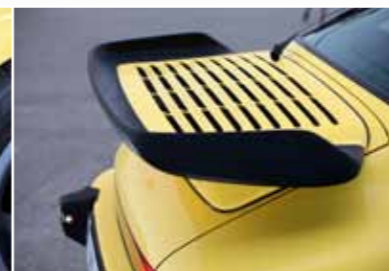
L'aile qui dissimule l'échangeur de chaleur est identique à la version "standard"
