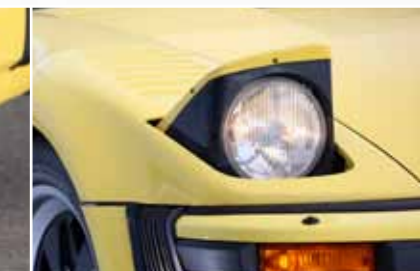
Les phares basculants sont commandés par un système de biellettes réalisées à l'unité
