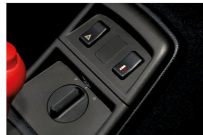
**10** La molette permet de monter et baisser l'aileron à l'arrêt, si on veut le nettoyer
