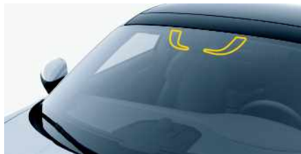
Fig. 120 : Fixation des appareils de péage
