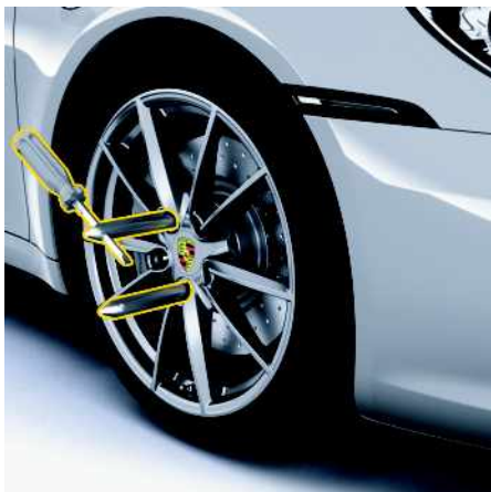
Fig. 129 : Vissage de deux auxiliaires de montage sur les véhicules avec PCCB
