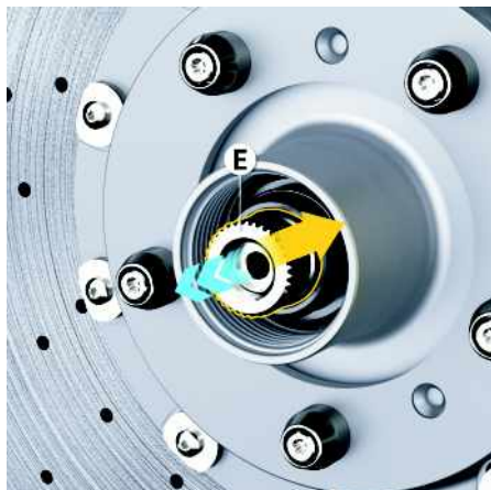
Fig. 139 : Contrôle de l'axe de sécurité
