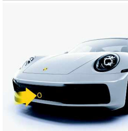
Fig. 193 : Position du capteur radar
