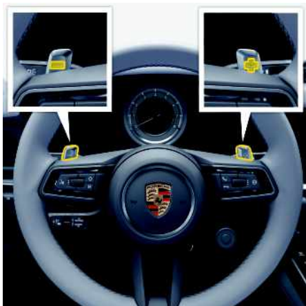
Fig. 26 : Volant avec palettes de passage de rapport
