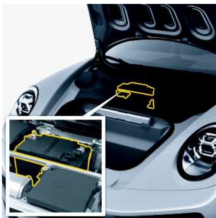
Fig. 21 : Batterie au lithium
