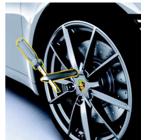
Fig. 128 : Vissage d'un auxiliaire de montage sur les véhicules sans PCCB
