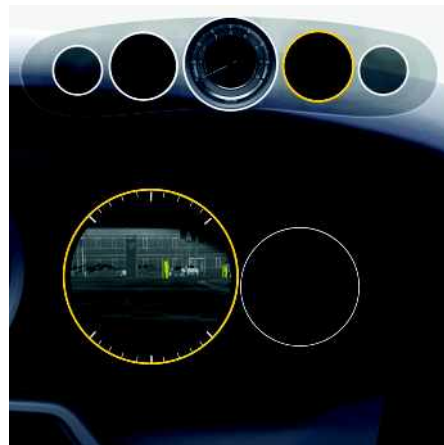
Fig. 30 : Image des différences thermiques de la caméra de vision nocturne
