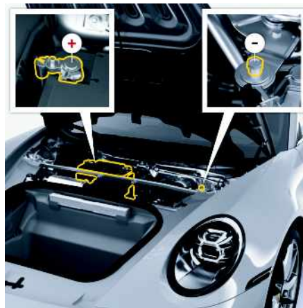
Fig. 20 : Bornes de la batterie au plomb
