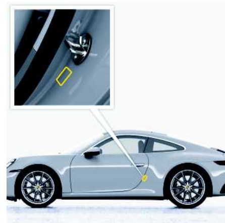
Fig. 278 : Emplacement de la plaque d'indication des pressions de gonflage des pneumatiques
