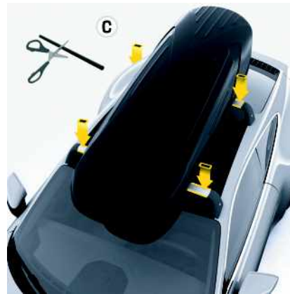
Fig. 244 : Découpe et montage des profilés
