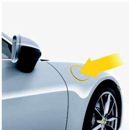
Fig. 189 : Ouverture de la trappe du réservoir
