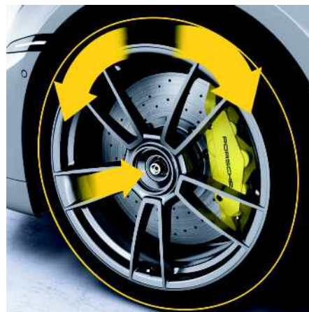
Fig. 140 : Installation de la roue sur le moyeu de roue
