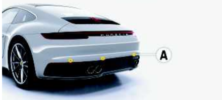
Fig. 16 : Capteurs utilisés pour la mesure de la distance
