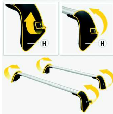
Fig. 238 : Déverrouillez les caches et rabattez-les vers le haut
