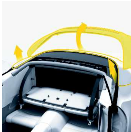
Fig. 51 : Mise en place du capot de puits de capote
