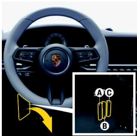
Fig. 107 : Boîte à fusibles dans le plancher côté conducteur
