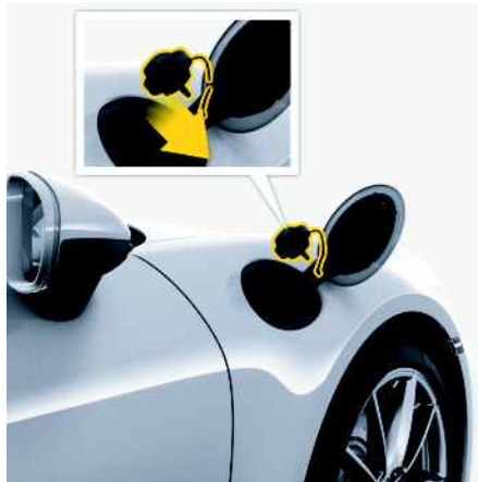
Fig. 190 : Ouverture du bouchon du réservoir
