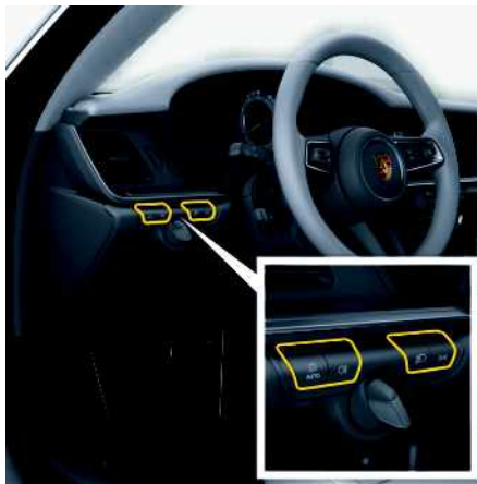
Fig. 96 : Panneau de commande de l'éclairage
