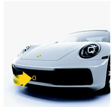
Fig. 164 : Position du capteur radar
