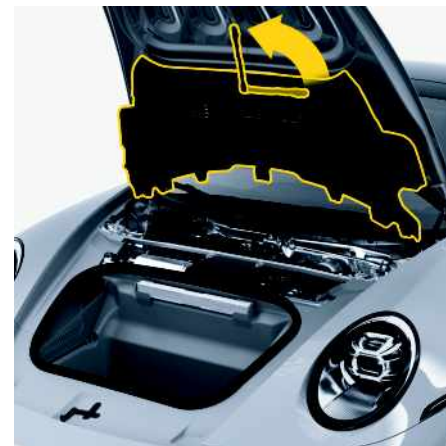
Fig. 81 : Accrochage du cache en plastique
