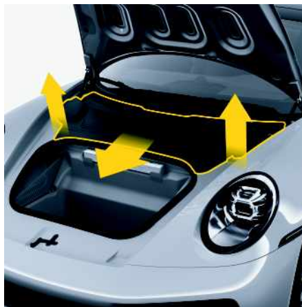
Fig. 80 : Dégagement et soulèvement du cache en plastique
