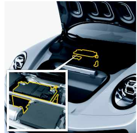
Fig. 19 : Batterie au plomb
