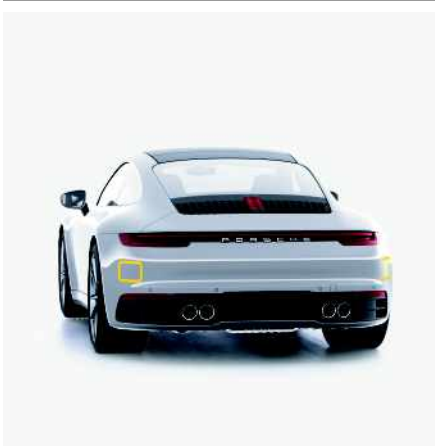
Fig. 9 : Capteurs radar dans le pare-chocs arrière
