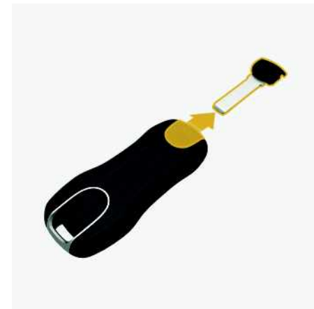
Fig. 68 : Retrait de la clé de secours
