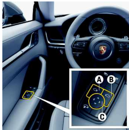
Fig. 206 : Pivotement du rétroviseur vers le bas pour l'assistance au stationnement
