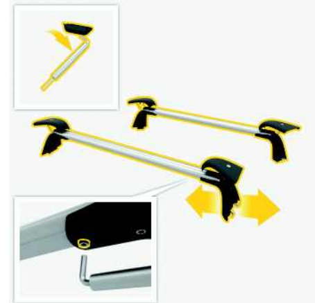
Fig. 239 : Desserrage des vis sur le dessous des supports
