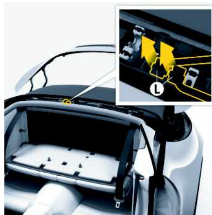
Fig. 59: Detaching connectors L.
