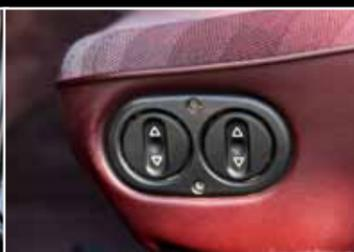
Le réglage en hauteur de l'assise des sièges se fait électriquement, les autres commandes étant manuelles
