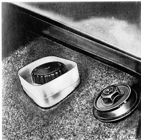
Le niveau du liquide dans le réservoir de compensation doit être contrôlé régulièrement et, si nécessaire, être complété. (En raison du diamètre important des cylindres des pinces de frein, le niveau du liquide dans le récipient compensateur est parfois en dessous de la moyenne de celui du frein à tambour, par exemple en cas d'usure des garnitures de frein.)
