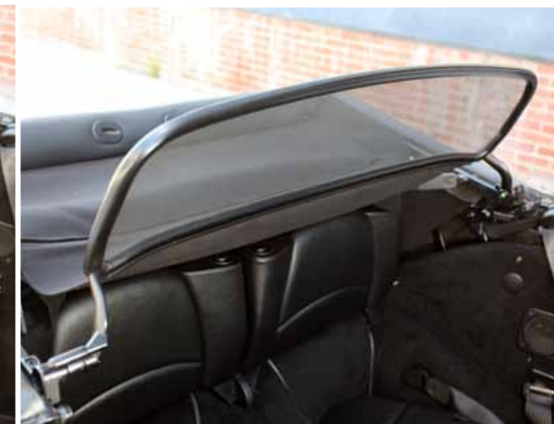
Déplié, le filet anti remous offre une excellente protection contre les courants d'air
