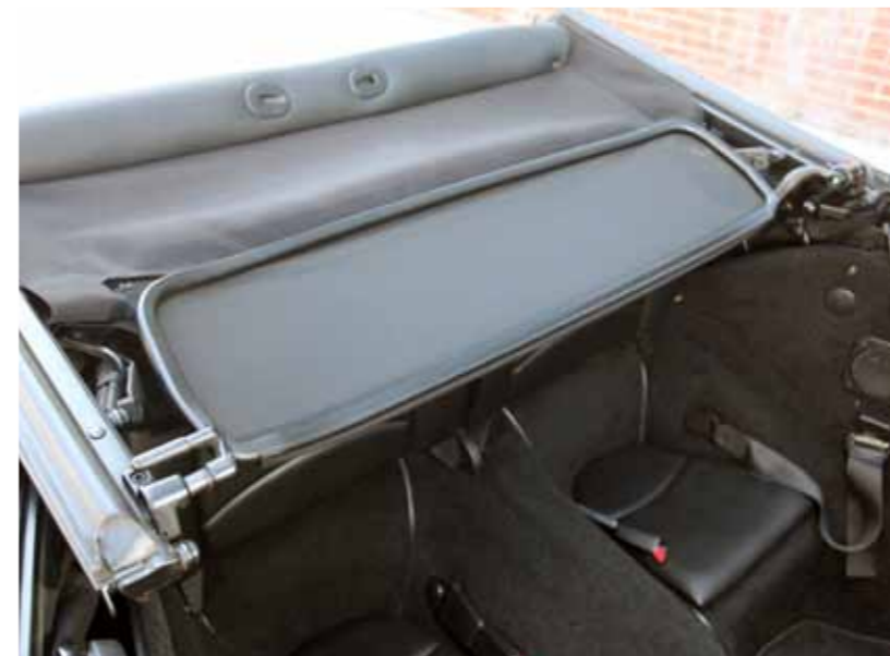
Le filet anti remous condamne malheureusement les places arrière
