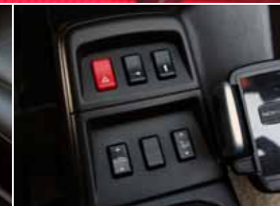
La capote entièrement électrique se commande depuis la console centrale
