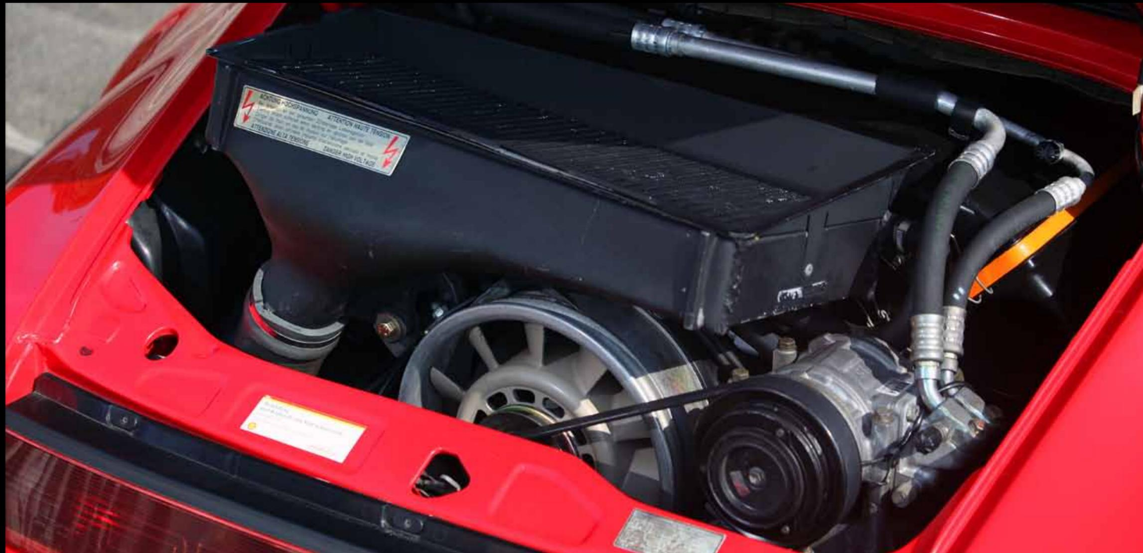
afin d'améliorer son efficacité. La turbine de refroidissement n'est plus entraînée par la même courroie que l'alternateur ce qui permet d'optimiser sa vitesse de rotation avec un rapport de 1,6 par rapport au vilebrequin. Le dessin des pales est aussi modifié afin d'augmenter le débit qui passe à 1 010 litres par minute à 6 000 tr/mn tout en ne consommant que l'équivalent de 8,3 ch.
