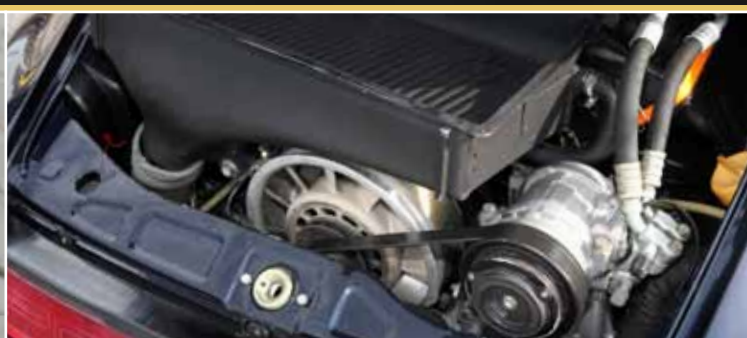
Le moteur de la Turbo 3.6 rentre sous le capot du cabriolet sans grandes modifications
