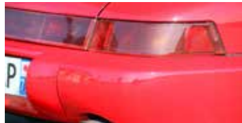
• Feux arrière Avec le temps, le bandeau et les feux arrière se décolorent et se fendillent. Il n'existe malheureusement pas d'autre solution que leur remplacement.
