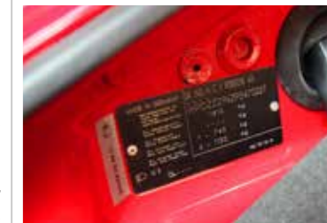
La plaque d'identification constructeur se situe sur la gauche du coffre avant
