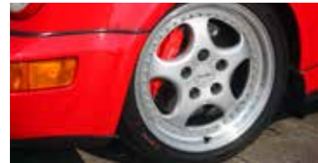
• Freins Les jantes de 18 pouces abritent des disques de 322 mm à l'avant pincés par des étriers à 4 pistons énormes pour l'époque.
