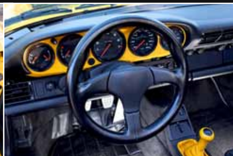
Ce volant sans airbag est plus dans l'esprit du Speedster que le gros volant des coupés
