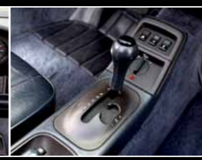
La 964 est la première 911 à avoir pu être équipée de la boîte Tiptronic
