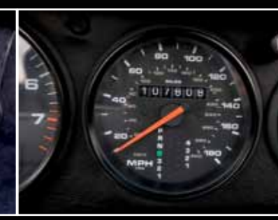
Sur le tachymètre, on retrouve le schéma de la boîte et l'affichage du rapport engagé
