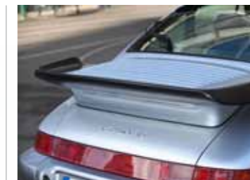
L'aile a un double rôle d'appui aérodynamique et de refroidissement de l'air de suralimentation
