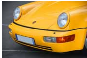
Les antibrouillards ont souvent été remplacés par des prises d'air pour refroidir les freins
