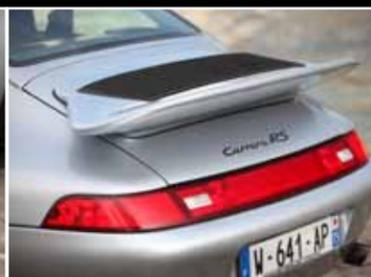
La Carrera RS est équipée d'un aileron fixe en lieu et place de l'aile mobile de la Carrera
