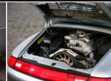
Les tubulures d'admission en alu sont signe de la présence du Varioram et du moteur 285 ch
